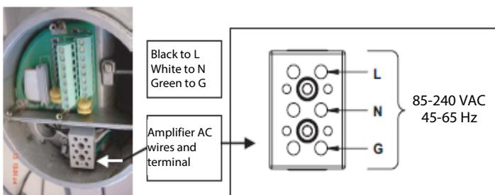
Figure 31: For AC wiring
